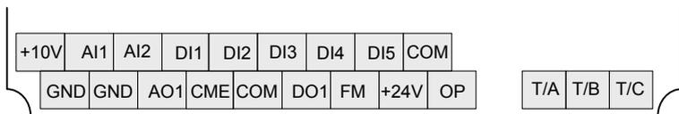
图 3-17 主控板端子分布示意图
